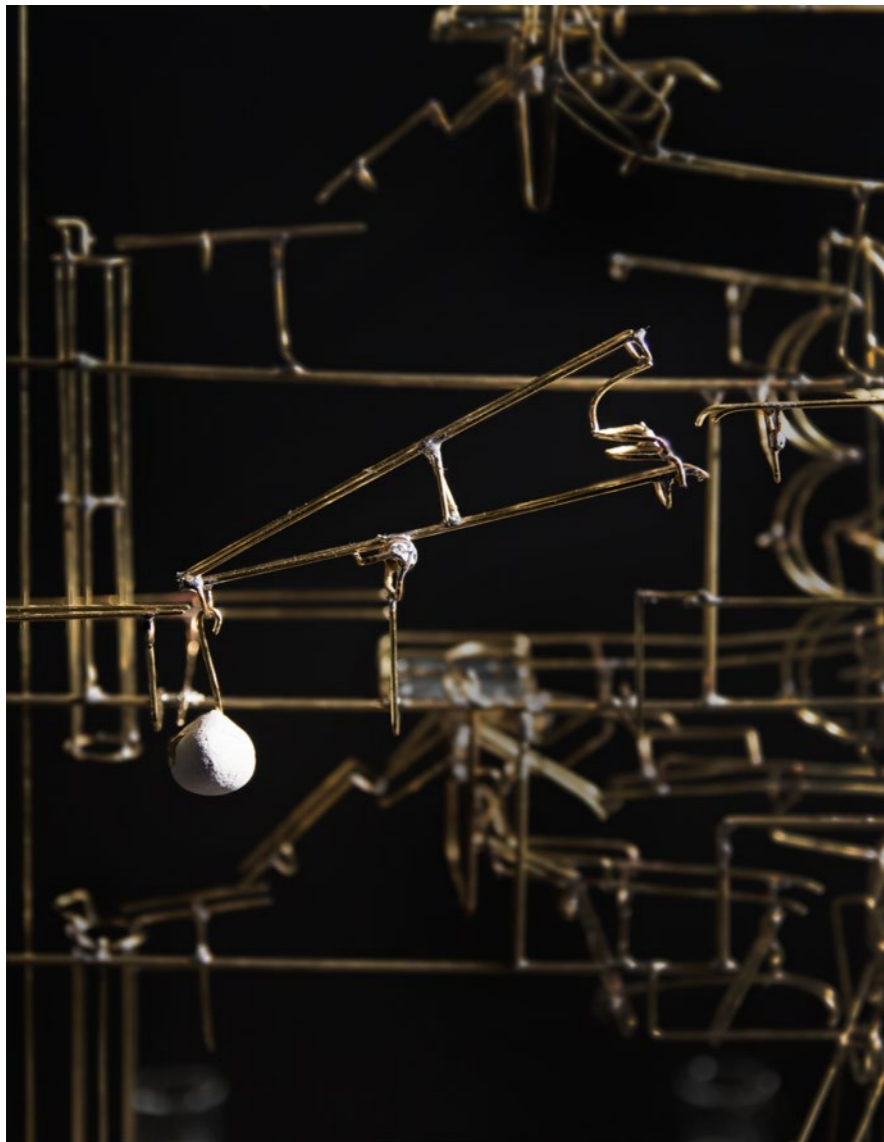
Die Wippe sortiert die eintreffende(n) Murmel(n) auf gegenüberliegende Bahnen, die aus verschiedenen Richtungen zu der Hebelmechanik führen.
