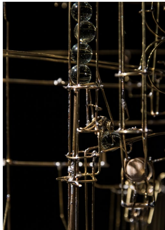
Die Übertragsmechanik im aktiven Zustand. Die eintreffende Murmel wird zurückgehalten, bis der Hebel in der zweiten Taktphase wieder gesenkt wird.
