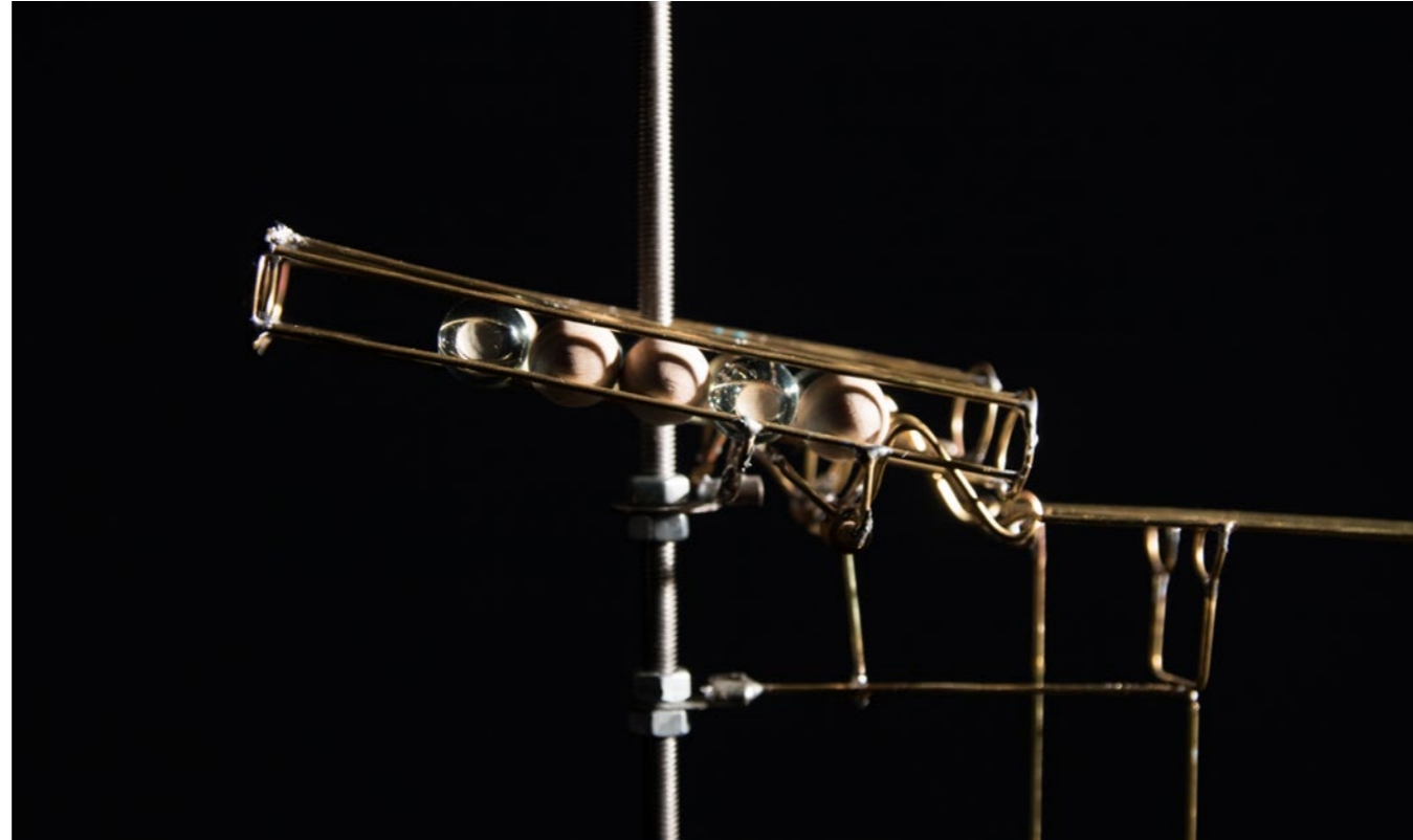
Input-Register befüllt mit dem Wert 10010 = 18
