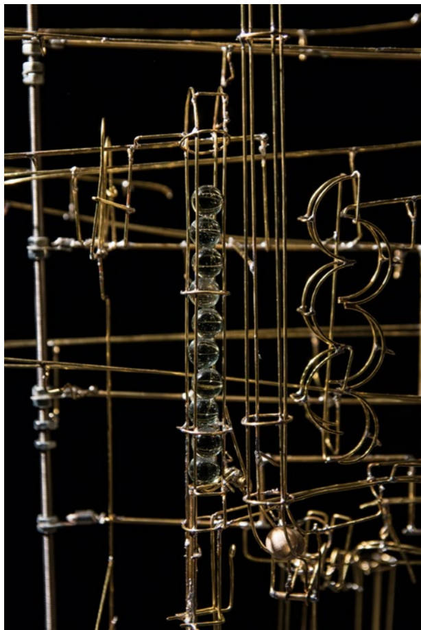
Die Übertragsmechanik im inaktiven Zustand. Die verschachtelten Bögen (rechts im Bild) bremsen den Fall von Murmeln aus dem ersten Halbaddierer.
