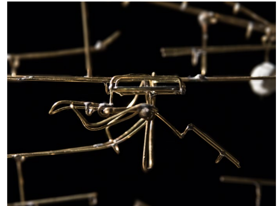
Die Hebelmechanik in der Profilsicht. Der linke Hebel führt zum Übertragsspeicher, der rechte in den Abfallschacht. Die mittlere Bahn dahinter führt in den zweiten Halbaddierer.
