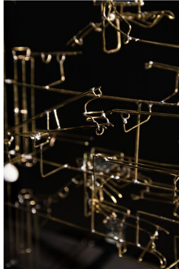
Detailansicht eines Halbaddierer-Bauelements
